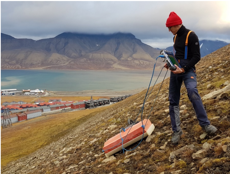
Figur 4: GPR målinger med 100 MHz antenne.
