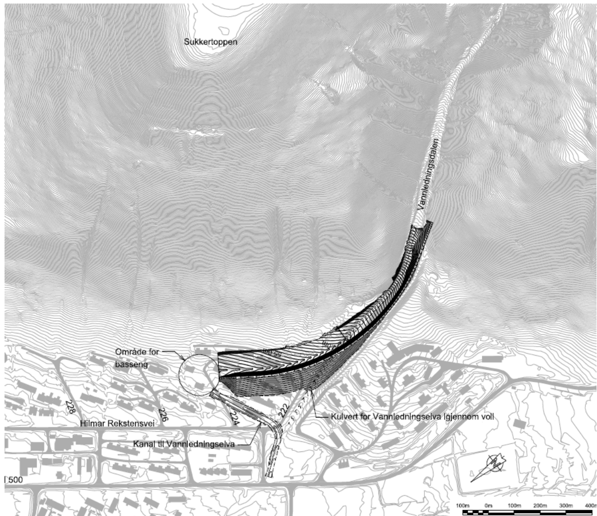
Figur 9? Svingvoll i Vannledningsdalen. Figuren viser også plassering av basseng og overvannskanal.
