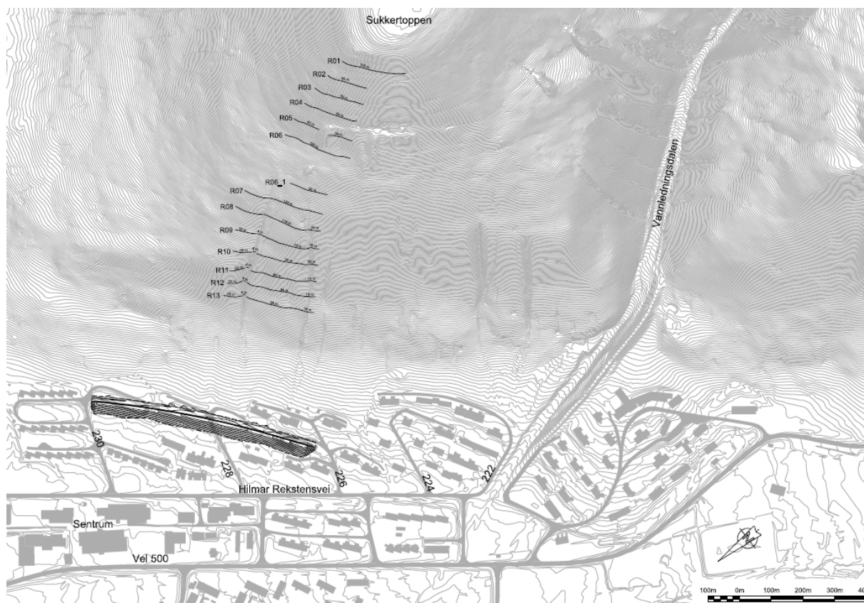
Figur 4 Støtteforbygninger i kombinasjon med lav fangvoll.
