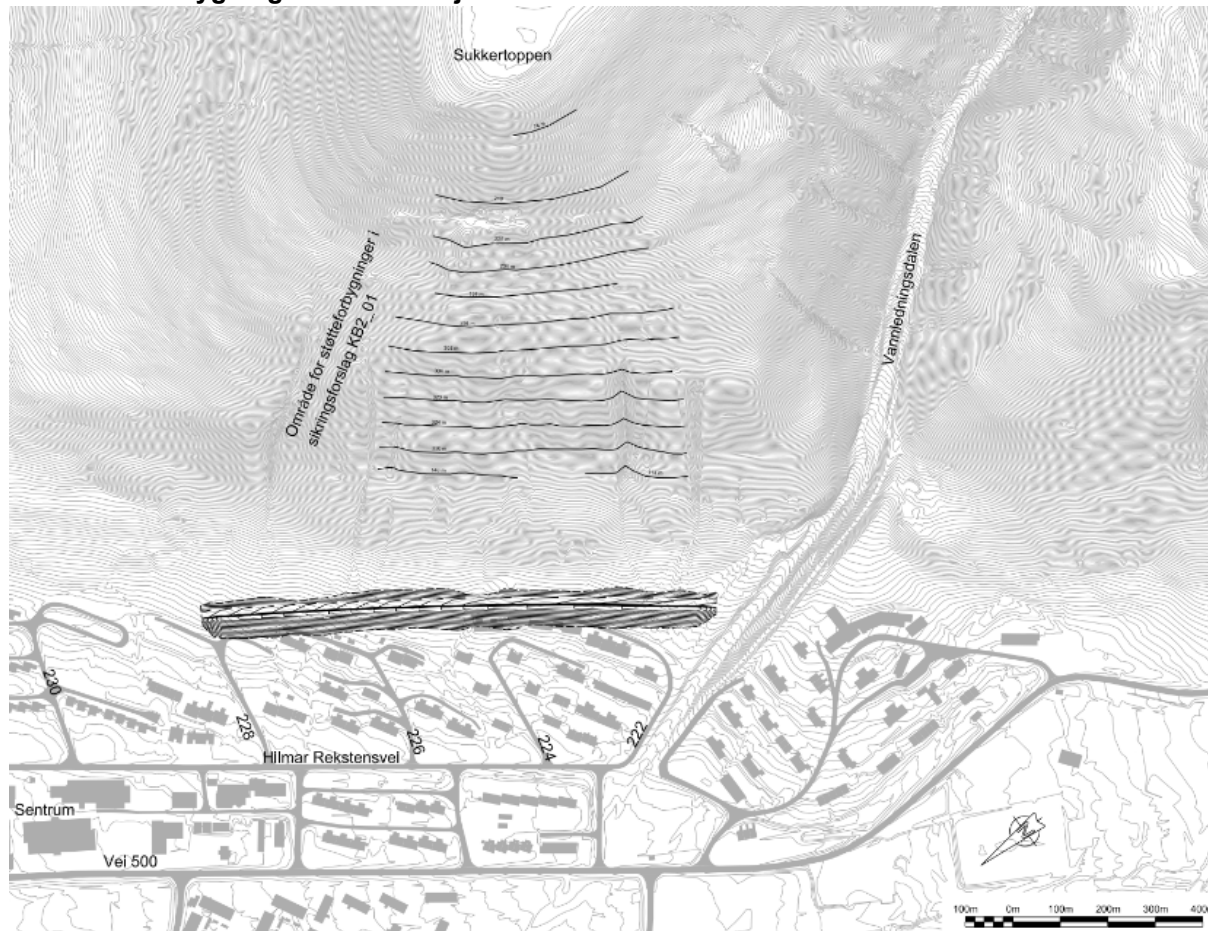
Figur 10 Støtteforbygninger i hele fjellsiden i kombinasjon med lav voll
